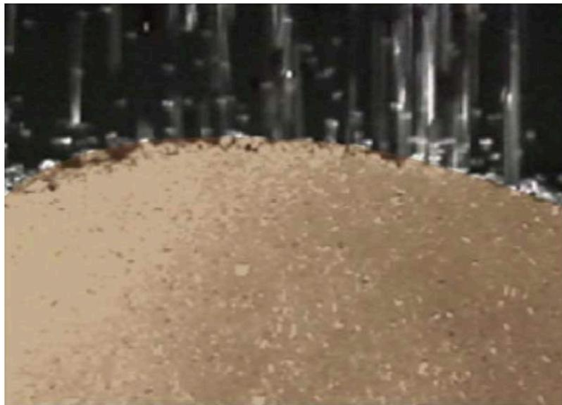
色の付いたポリエステルチップを製造機に入れて熱で液化する。
